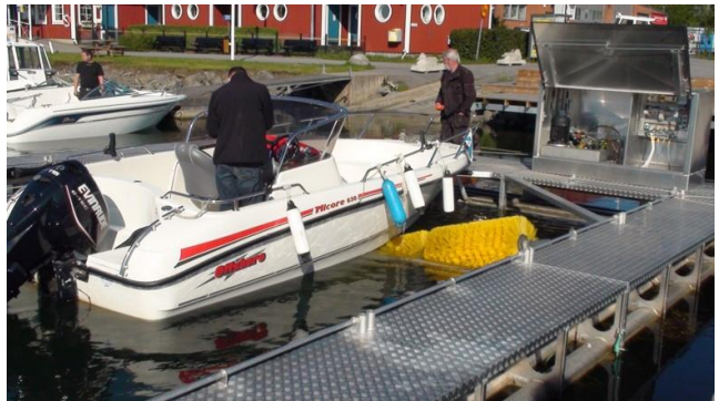
Paatide „pesumaja“ Gotlandi saarel. Paadipõhjade puhastamine on keskkonnasäästlik alternatiiv tinaorgaanikat sisaldavatele mürgistele värvidele.
